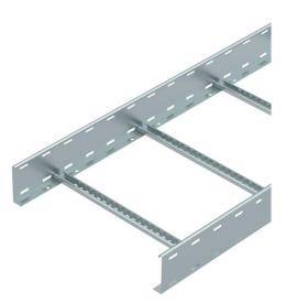
Kabelleiter mit gelochtem Seitenholm in der Seitenhöhe 110 mm mit eingenieteten, nach oben offenen C-Profil-Sprossen. Die Kabelleiter wird in zusammengeklappter Ausführung geliefert.
