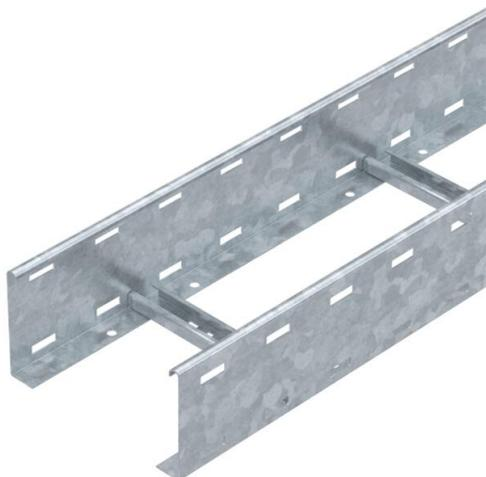
Kabelleiter mit gelochtem Seitenholm in der Seitenhöhe 110 mm mit eingienieteten, nach oben offenen C-Profil-Sprossen.
