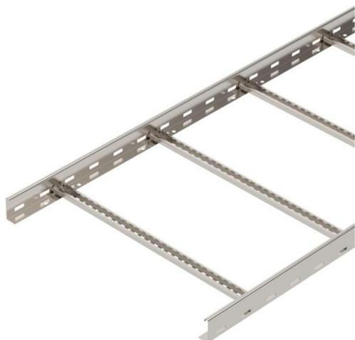
Kabelleiter in Seitenhöhe 60 mm mit eingeschweißten, nach oben offenen C30-Profil Sprossen. Eingerollter Seitenholm zur Verstärkung und als Kantenschutz. Die Befestigung auf dem Ausleger erfolgt mit Klemmstücken Typ LKS 40. Das Schlitzmaß der Sprosse beträgt 16,5 mm, die passende Bügelschelle ist der Typ 2056.
