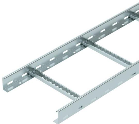
Kabelleiter in Seitenhöhe 60 mm mit eingeschweißten, nach oben offenen C30 Profilsprossen. Eingerollter Seitenholm zur Verstärkung und als Kantenschutz. Die Befestigung auf dem Ausleger erfolgt mit Klemmstücken Typ LKS 40. Das Schlitzmaß der Sprosse beträgt 16,5 mm, die passende Bügelschelle ist der Typ 2056.
