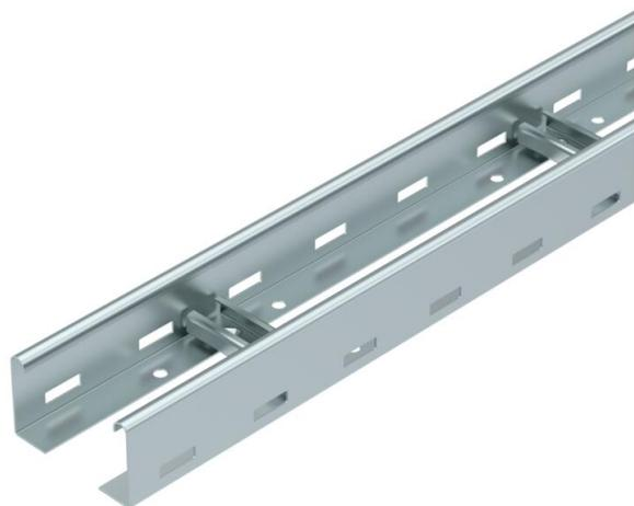
Kabelleiter in Seitenhöhe 60 mm mit eingeschweißten, nach oben offenen C30 Profilsprossen. Eingerollter Seitenholm zur Verstärkung und als Kantenschutz. Die Befestigung auf dem Ausleger erfolgt mit Klemmstücken Typ LKS 40. Das Schlitzmaß der Sprosse beträgt 16,5 mm, die passende Bügelschelle ist der Typ 2056.
