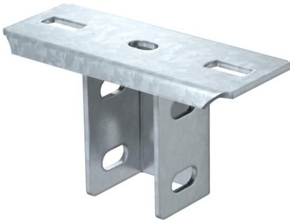
Kopfplatte für die Montage an US 5- Stiele. In Kombination mit dem US 5- Stiel können Hängestiele in allen Längen vor Ort hergestellt werden. Ebenfalls geeignet für die Fixierung von Steigeleitern Typ SLM 50. Die Kopfplatte kann an Fixlängen des U- Stiels Typ US 5 montiert werden. Bei der Montage der Kopfplatte wird das Distanzstück Typ DSK 45 eingesetzt.
