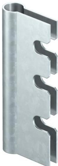
Adapter zur Aufnahme der Gewindestange bei der Anwendung des Brandschutzkanals PYROLINE® Con S BSKH als E-Kanal im Funktionserhalt. Der Adapter wird direkt an den Verbindungsblechen des Kanals befestigt.
