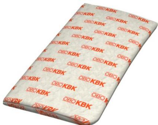
Kabel-Brandschutzkissen aus engmaschigem, dichtem und mechanisch festem Glasgewebe mit Spezialfüllung. Frei von Mineralfasern, wetterfest und wasserunempfindlich. Anwendung im Innenbereich.
