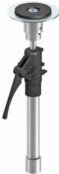
Spannvorrichtung zum Verspannen der Boden-Decken-Installationssäulen gegen die Decke. Der Nivellierbereich liegt zwischen 313 (Basislänge) und 480 mm.
