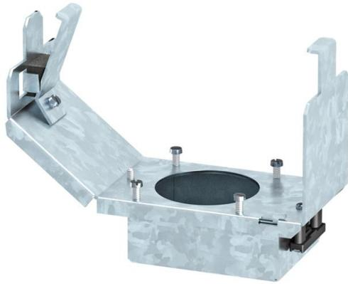
Geräteträger der Nenngröße 2 für den Einbau einer CEE-Steckverbindung 16 A oder 32 A zum Einbau in Geräteinsätzen und Kassetten der Nenngröße 2, 4, 6 und R7. Geräteträger mit Schutzgehäuse und Zugentlastung. Benötigte Mindeststeinbautiefe: 190 mm bei Verwendung eines Geradeaus-Steckers und 160 mm bei Verwendung eines Winkelsteckers.
