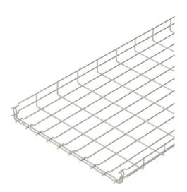
Gitterrinne mit angeformtem Verbinder in der Seitenhöhe 55 mm. Für die Gitterrinne werden keine zusätzlichen Verbinderbauteile benötigt, sie wird einfach ineinandergesteckt. Die Maschenweite beträgt 50 x 100 mm (Ausnahme GRM 55/50 = 20 x 100 mm).
