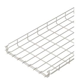
Gitterrinne mit angeformtem Verbinder in der Seitenhöhe 55 mm. Für die Gitterrinne werden keine zusätzlichen Verbinderbauteile benötigt, sie wird einfach ineinandergesteckt. Die Maschenweite beträgt 50 x 100 mm (Ausnahme GRM 55/50 = 20 x 100 mm).
