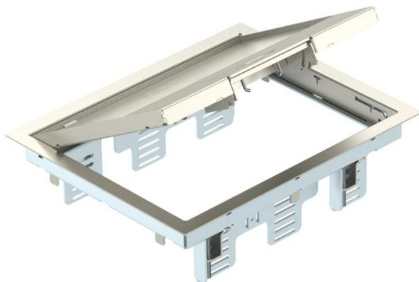
Geräteinsatz mit Griffbügel für bis zu 9 Modul 45-Einzelgeräte in 3 Universalträger UT3, Einsatz in Kanalsystemen und Systemböden im Innenbereich. Rastleiter aus verzinktem Stahlblech. Die Bodenbelagsdicke ist auf 5 mm eingestellt, bei Bedarf anpassbar auf 10 mm. Bis zu 6 Installationsgeräte mit 50er Zentralplatte einsetzbar.
