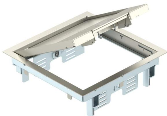
Geräteinsatz mit Griffbügel für bis zu 6 Modul 45-Einzelgeräte in 2 Universalträger UT3, Einsatz in Kanalsystemen und Systemböden im Innenbereich. Rastleiter aus verzinktem Stahlblech. Die Bodenbelagsdicke ist auf 5 mm eingestellt, bei Bedarf anpassbar auf 10 mm. Bis zu 4 Installationsgeräte mit 50er Zentralplatte einsetzbar. Geräteinsatz mit Griffbügel, 2-zügig, für den Einbau des Montageträger MT4. Es können 2 Abdeckplatten der Bauform APMT2 installiert werden.
