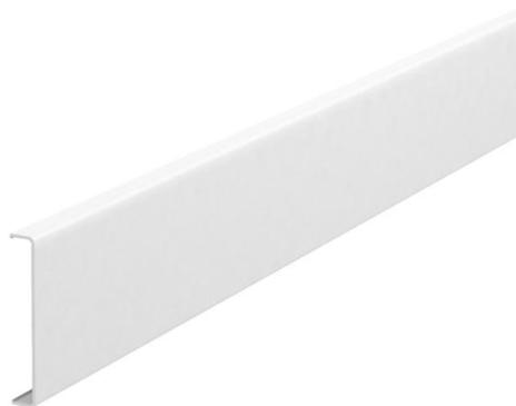
Oberteil aus Aluminium zum Verschließen der Rapid GA Geräteinbaukanäle und ISS Installationssäulen mit 76,5er Systemöffnung. Der feste Sitz des Oberteils und die elektrische Kontaktierung zum Kanal-/Säulenunterteil ist durch die Rastklammern Typ RKV3V garantiert. In jeder Lieferlänge (2000mm) sind 6 Rastklammern vormontiert.
