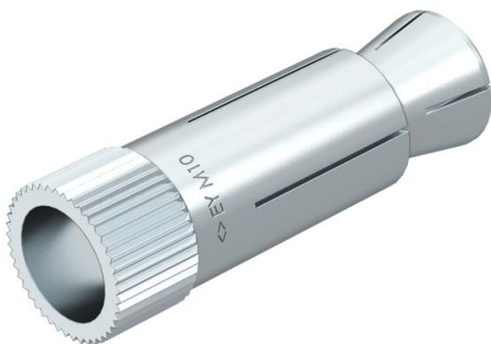
Hohldeckenanker Easy für die Montage in Spannbeton-Hohldeckenplatten. Beim Anziehen der Schraube oder der Mutter wird der Konus von der Ankerhülse gelöst und in diese hineingezogen. Dadurch spreizt der Dübel im Hohlraum auf und erzeugt einen Formschluss. Der Hohldeckenanker kann auch eingesetzt werden, wenn der Spreizbereich nicht in einer Hohlkammer liegt. Die Bauteilbefestigung kann mit handelsüblichen Schrauben und Gewindestangen erfolgen.
