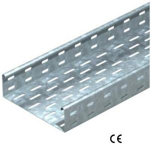
EKS 60 = Extraschweres-Kabelrinnen-System in 60 mm Seitenhöhe. Längsverbinder sind bei allen Ausführungen anteilig separat zu bestellen. Magnetische Schirmdämpfung ohne Deckel 20 dB, mit Deckel 50 dB.
