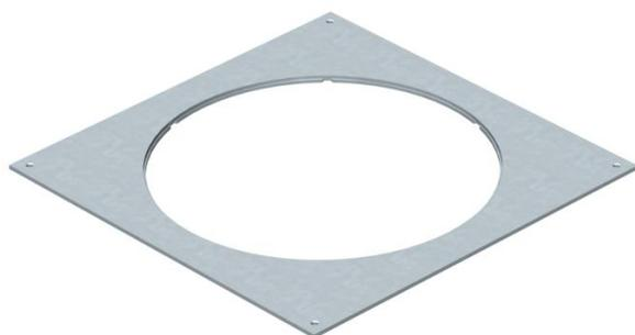
Montagedeckel für Unterflur-Zug- und -Abzweigdosen vom Typ UZD350-3/4 zum Einbau einer Einbaueinheit der Nenngröße R7. Einbauöffnung 3 mm vertieft zum nachträglichen Blindverschluss mit Deckelblindplatte.
