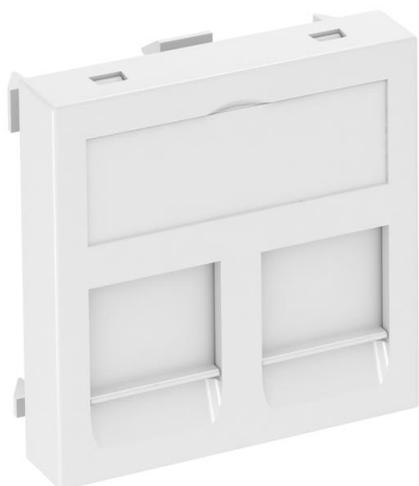
Datentechnikträger mit geradem Auslass und Verschlussschieber zur Aufnahme von zwei Datentechnik-Anschlussmodulen mit RJ45-Buchse. Die Rastbefestigung eignet sich für den waagerechten und senkrechten Einbau in die Systemumgebung. Typ F hat eine spezielle Modulaufnahme und ist für eine indirekte Befestigung der Daten-Anschlussmodule in der Montageöffnung ausgelegt. Datentechnikträger Typ F ist für die Aufnahme der nachfolgenden Daten-Anschlussmodule geeignet: Avaya/Systemax: M-Serie.
