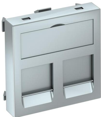
Datentechnikträger mit geradem Auslass und Verschlussschieber zur Aufnahme von zwei Datentechnik-Anschlussmodulen mit RJ45-Buchse. Die Rastbefestigung eignet sich für den waagerechten und senkrechten Einbau in die Systemumgebung. Typ A hat eine Montageöffnung von 20,10 x 14,80 mm und ist für die direkte Befestigung der Daten-Anschlussmodule in der Montageöffnung ausgelegt.
