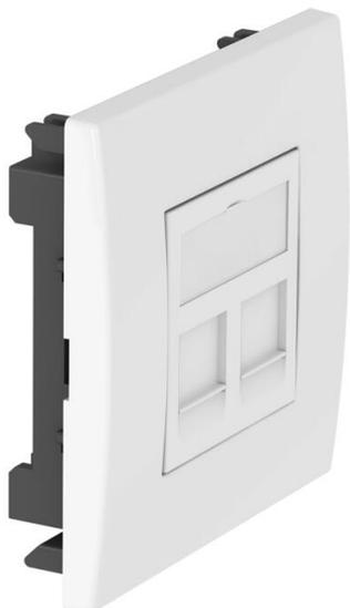
Einbaueinheit zur Aufnahme von zwei Datentechnikmodulen Typ A, geeignet für den Einbau in Geräteeinbau-Kanalsysteme Rapid 80 und Installationssäulen ISS. Datentechnikträger Typ A ist für die Aufnahme der nachfolgenden Daten-Anschlussmodule geeignet: AMP TYCO (ohne Staubschutzklappe): SL Serie 110Connect und SL Serie Toolless; Brand-Rex: Module mit Artikelnummer-Endung ...JAKS000CR und ...JAKU002; Nexans: LANmark RJ45 mit blauen Adapter-Clip, LANmark GG45 mit Metall-Clip.
