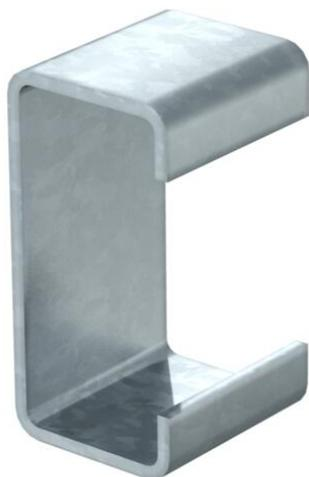
Distanzstück zum Einsatz in US 5-Stiel oder in die Kopfplatte Typ KU 7 VQP. Das Distanzstück wird zur Vergrößerung der Stabilität immer eingesetzt, damit der Stiel beim Anziehen des Auslegers mit durchgängigen Sechskantschrauben nicht verformt wird.
