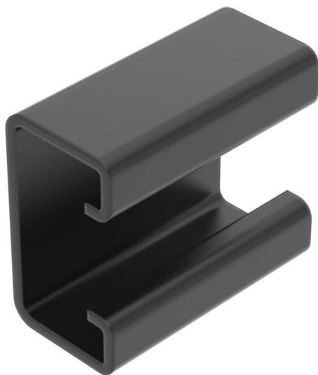
Distanzstück zum Stabilisieren von US 3-Profilen, verhindert Verformung des Stiels oder Hängestiels bei Montage eines Auslegers mit durchgängiger Sechskantschraube. Befestigungsmaterial muss separat bestellt werden. Pulverbeschichtet in tiefschwarz (RAL 9005).
