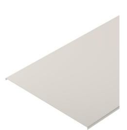
Ungelochter Deckel zum Abdecken von Kabelrinnen und Gitterrinnen. Quersicke ab der Breite 500 mm. Bei Verwendung von Deckeln im Außenbereich sind zusätzliche Maßnahmen gegen Windeinflüsse vorzunehmen.
