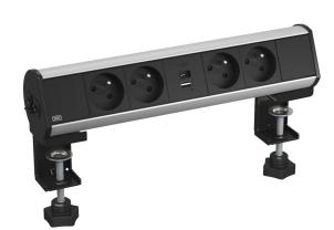
Anschlussfertige Deskbox DBL zur direkten Versorgung von Arbeitsplätzen mit Energieanschlüssen. Mit einem Wieland GST18®-Anschluss und Kabelauslass von links aus dem Profil. Werkzeuglose Montage mit 2 Befestigungszwingen für Tischplattenstärken von 8 bis 40 mm und 40 bis 70 mm. Die Deskbox ist mit 4 schwarzen NF-Steckdosen und einem 18W USB A+C USB-Charger bestückt.
