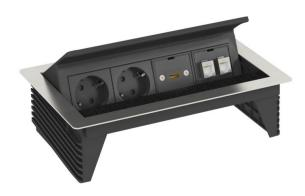
Klappbare Deskbox mit Anschlusskabel, für den festen Einbau in eine Tischplatte, Gehäuse aus gebürstetem Edelstahl mit Bürstenleiste als Leitungsauslass. Die Montage erfolgt über eine Einbauöffnung 245 x 157 mm in der Tischplatte.
