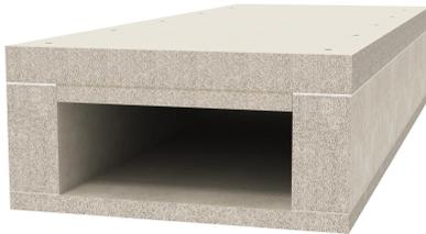
Brandschutzkanal aus wasser- und frostbeständigen Glasfaserleichtbeton der Baustoffklasse A1 gemäß EN 13501-1 zur brandsicheren Verlegung von Kabeln in Flucht- und Rettungswegen und zum Funktionserhalt sicherheitsrelevanter Anlagen. Klassifizierung I120 als I-Kanal gemäß DIN 4102 Teil 11 und Klassifizierung E90 als E-Kanal gemäß DIN 4102 Teil 12.
