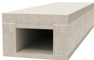
Brandschutzkanal aus wasser- und frostbeständigen Glasfaserleichtbeton der Baustoffklasse A1 gemäß EN 13501-1 zur brandsicheren Verlegung von Kabeln in Flucht- und Rettungswegen und zum Funktionserhalt sicherheitsrelevanter Anlagen. Klassifizierung I120 als I-Kanal gemäß DIN 4102 Teil 11 und Klassifizierung E90 als E-Kanal gemäß DIN 4102 Teil 12.
