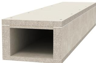
Brandschutzkanal aus wasser- und frostbeständigen Glasfaserleichtbeton der Baustoffklasse A1 gemäß EN 13501-1 zur brandsicheren Verlegung von Kabeln in Flucht- und Rettungswegen und zum Funktionserhalt sicherheitsrelevanter Anlagen. Klassifizierung I90 als I-Kanal gemäß DIN 4102 Teil 11 und Klassifizierung E30 als E-Kanal gemäß DIN 4102 Teil 12.
