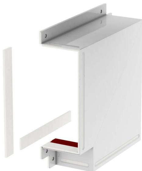
Formteil-Haube zur Abdeckung von zwei Kanälenden BSKM 1025 als Flachwinkel bei direkter Wand- und Deckenmontage. Inklusive eingeklebter Dichtungen zum Abdichten der Fugen und losen Dichtungen bei Kombination mit Gegenplatte, sowie Schrauben für den Potentialausgleich.
