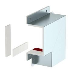
Formteil-Haube zur Abdeckung von zwei Kanalenden BSKM 0711 als Flachwinkel bei direkter Wand- und Deckenmontage. Inklusive eingeklebten Dichtungen zum Abdichten der Fugen und losen Dichtungen bei Kombination mit Gegenplatte, sowie Schrauben für den Potentialausgleich.
