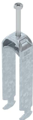
Bügelschelle mit Hammerkopf-Fuß, Metalldruckwanne mit gerundeten Kanten für Kabelschutz. Zur vertikalen und horizontalen Montage von 3 Einzelkabeln an C-Profilschiene. Für Schlitzweite 16 - 17 mm. Mit 1-gängiger Schraube an Druckwanne, universeller Sechskant-Schraubenkopf SW10, mit Schlitz und Kreuzschlitz. Geeignet für Montage im Innen- und Außenbereich. Mehrere Kabel sollten durch Doppelwannen getrennt werden. Der Einsatz einer Gegenwanne wird empfohlen.
