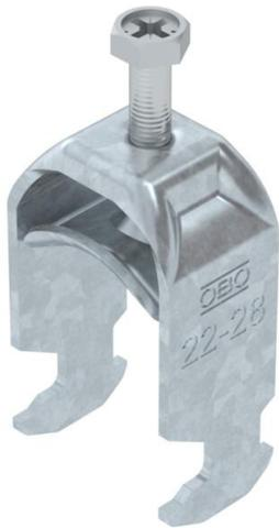
Bügelschelle mit Hammerkopf-Fuß, Metalldruckwanne mit gerundeten Kanten für Kabelschutz. Zur vertikalen und horizontalen Montage von 1 Einzelkabel an C-Profileschiene. Für Schlitzweite 16 - 17 mm. Mit 1-gängiger Schraube an Druckwanne, universeller Sechskant-Schraubenkopf SW10, mit Schlitz und Kreuzschlitz. Geeignet für Montage im Innen- und Außenbereich. Gegenwanne muss separat bestellt werden.
