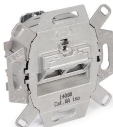
UAE Cat. 6 A ISO 8/8 Anschlussdose mit abbrechbarem Tragrings für Stegversion. 2 Anschlüsse. Erfüllt die höchsten übertragungstechnischen Produktanforderungen gemäß ISO/IEC 11 801:2011-06 für 500 MHz Bandbreite (10 Gbit/s). Zentralplatte nicht im Lieferumfang enthalten, muss separat bestellt werden.
