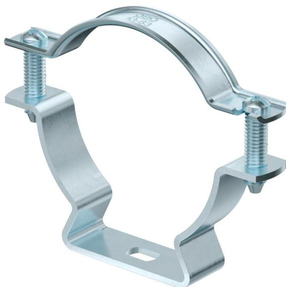
Abstandschelle zur Montage von Röhren und Kabeln an Wand, Decke und Boden. Mit selbstsicherndem Oberteil. Befestigung über Langloch. Zugelassen für den Funktionserhalt nach DIN 4102 Teil 12, Funktionserhaltklassen E 30 bis E 90.
