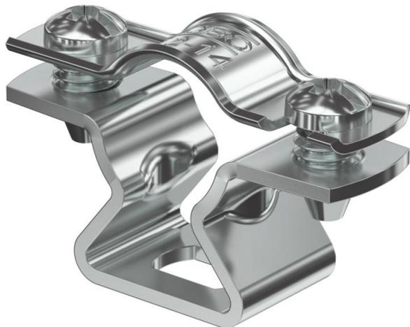
Abstandschelle zur Montage von Rohren und Kabeln an Wand, Decke und Boden. Mit selbstsicherndem Oberteil. Befestigung über Langloch. Ab der Schellengröße 20 geeignet für Montage mit Nagelgerät oder Bolzensetzgerät. Zugelassen für den Funktionserhalt nach DIN 4102 Teil 12, Funktionserhaltklassen E 30 bis E 90 (außer ALU).
