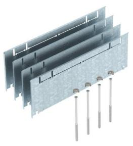
Höhenausgleich-Bausatz für Unterflurdosen UZD350-3 mit einer Bauhöhe von 70 bis 125 mm, bestehend aus 4 Fallblechen, 4 Nivellierschrauben und 4 Drehverschlüssen.
