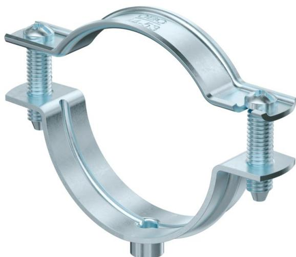
Abstandschele zur Montage von Röhren und Kabeln an Wand, Decke und Boden. Mit selbstsicherndem Oberteil. Befestigung über Ansatz mit Innengewinde. Zugelassen für den Funktionserhalt nach DIN 4102 Teil 12, Funktionserhaltklassen E 30 bis E 90.
