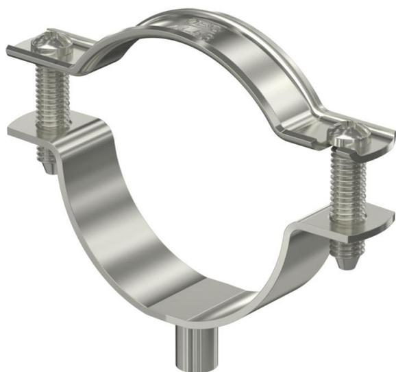
Abstandschelle zur Montage von Rohren und Kabeln an Wand, Decke und Boden. Mit selbstsicherndem Oberteil. Befestigung über Ansatz mit Innengewinde. Zugelassen für den Funktionserhalt nach DIN 4102 Teil 12, Funktionserhaltklassen E 30 bis E 90.
