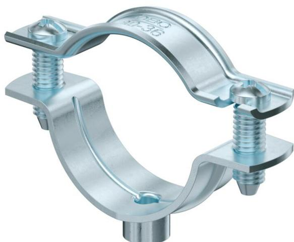
Abstandschele zur Montage von Röhren und Kabeln an Wand, Decke und Boden. Mit selbstsicherndem Oberteil. Befestigung über Ansatz mit Innengewinde. Zugelassen für den Funktionserhalt nach DIN 4102 Teil 12, Funktionserhaltklassen E 30 bis E 90.
