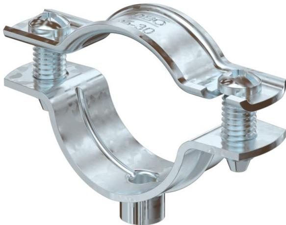
Abstandschelle zur Montage von Rohren und Kabeln an Wand, Decke und Boden. Mit selbstsicherndem Oberteil. Befestigung über Ansatz mit Innengewinde. Oberflächen G und FT ab Schellengröße 20 geeignet für Montage mit Nagelgerät oder Bolzensetzgerät. Zugelassen für den Funktionserhalt nach DIN 4102 Teil 12, Funktionserhaltklassen E 30 bis E 90.
