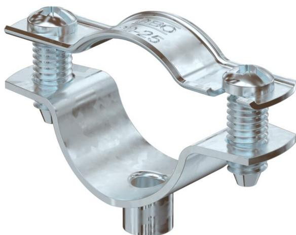
Abstandschele zur Montage von Röhren und Kabeln an Wand, Decke und Boden. Mit selbstsicherndem Oberteil. Befestigung über Ansatz mit Innengewinde. Oberflächen G und FT ab Schellengröße 20 geeignet für Montage mit Nagelgerät oder Bolzensetzgerät. Zugelassen für den Funktionserhalt nach DIN 4102 Teil 12, Funktionserhaltklassen E 30 bis E 90.
