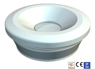
Geschlossener Einführungsnippel mit Durchstoßmembrane für Kabeldurchmesser 7-13 mm. Ideal zur einfachen Kabel und Leitungseinführung in Gehäusen oder durch dünnwandige Bleche.
