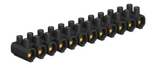
Geprüft nach EN 60998. Klemmen Messing, Schrauben Stahl, galvanisch verzinkt, 12-polige, in Einzelklemmen abtrennbare Leisten. Schrauben hochgedreht, unverlierbar. Max. zulässige Umgebungstemperatur gemäß EN 60998: -5 bis +80 °C. Nennquerschnitt 35 ÷ mm² Nennspannung 750 V Nennstrom 125 A Max. klemmbar je Seite: 35 mm² mehrdrähtig oder 25 mm² feindrähtig.
