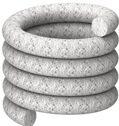
Die Schallschutzbarriere dient zur Minderung der Luftschall-Übertragung z. B. bei Führung des Kanalsystems durch Wanddurchbrüche zwischen zwei Büros. Die Schallschutzbarriere besteht aus Glaswolle, die im Lieferzustand einen Durchmesser von ca. 30 mm hat. Die Meterware wird in einem Karton angeliefert, die Länge des Materials ist 50 m. Das Material braucht bei der Montage nicht extrem komprimiert zu werden.
