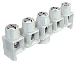
Klemmkörper Messing, vernickelt, Schrauben Stahl, galvanisch verzinkt und transparent passiviert, Nennquerschnitt 0,8 ÷ 2,5 mm<sup>2</sup>, Nennspannung 660 V, 5polig, mit Buchsenklemmen, max. anschließbare Querschnitte je Klemmstelle: 4 x 2,5 mm<sup>2</sup>, 5 x 1,5 mm<sup>2</sup> oder 6 x 1 mm<sup>2</sup>, nicht benötigte Pole können abgetrennt und als Einzelklemme verwendet werden.
