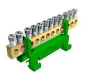
Schutzleiter- Anschlussklemme mit 7 Klemmstellen bis 16 mm². Klemmschiene Messing, Schrauben Stahl, galvanisch verzinkt und transparent passiviert, zum Aufrasten auf Hutprofilschiene  $35 \times 7,5$  mm nach DIN EN 60715 (früher DIN EN 50022) (quer) oder Flachschienen  $10 \times 2$ -2,5 mm (längs).
