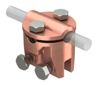
• Blechstärke bis 7 mm • Für Leitungsverlauf quer und parallel zum Blech mit 4 Sechskantschrauben M6 x 16 • Entspricht den Anforderungen nach VDE 0185-305 (IEC 62305)
