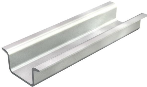
Hutprofilschiene 35 x 15 mm ähnlich DIN EN 60715 (früher DIN EN 50022), jedoch mit Materialstärke 1,5 mm.
