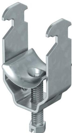
Passend zu allen C-Profileschienen mit 16 - 17 mm Schlitzweite. Schelle, Schraube und Druckwanne aus tauchfeuerverzinktem Stahl.
